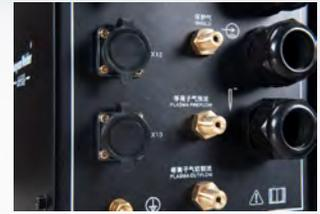
气路短，更易得到稳定的气体流量，实现准确控制送气时序，提升切割质量
